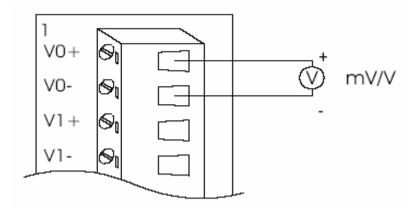
Figure 8: Millivolt and volt input
