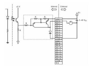
Figure 44: ADAM-5056S module wiring diagram
