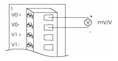
Figure 5: Millivolt and volt input
