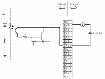
Figure 46: ADAM-5056SO module wiring diagram
