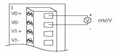
Figure 11: Millivolt and volt input
