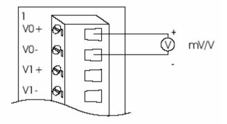
Figure 12: Millivolt and volt input
