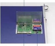
DDR2 socket CompactFlash socket
