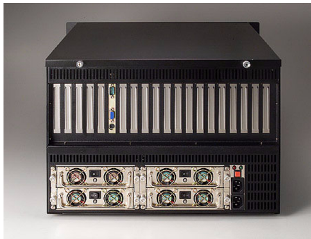
(b) power supply module of 570 W / 810 W/570W/810W 电源模块 /570W/810W 電源模組
