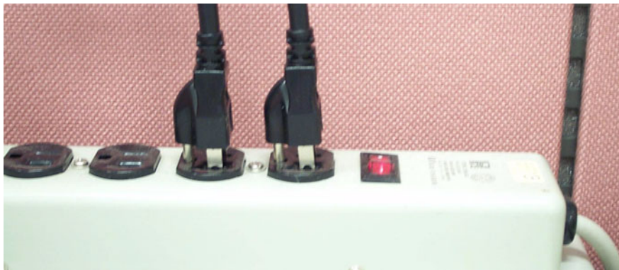
Figure 3.8 Power cord plugs orientation on the socket/ 插座上电源线方向应相同 / 插座上的電源線方向應相同
