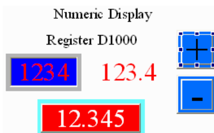
Рис. 3.2.6 Пример кнопок "Increment / Decrement"
