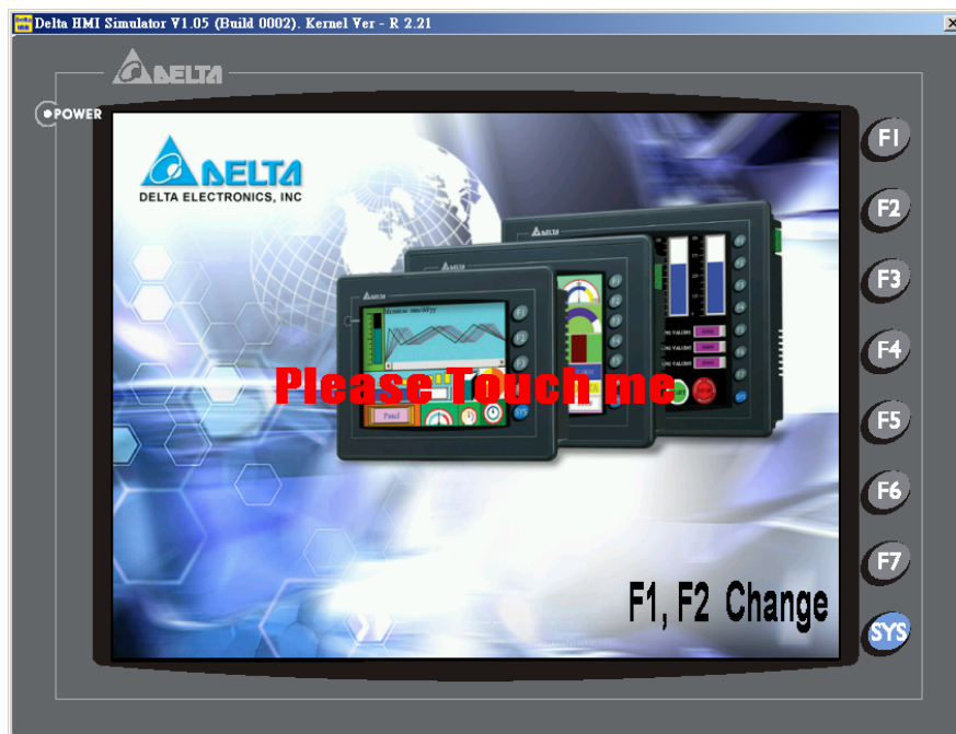
Рис. 2.8.15 Экран отладки программы в режиме онлайн
