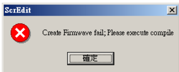
Рис. 2.3.16 Сообщение об ошибке при попытке записать на SMC-карту нескопированную прикладную программу
