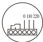
SA A 110V/220VAC Relay output
