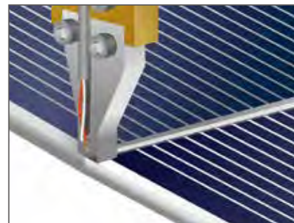
Приварювання провідників сонячних панелей
