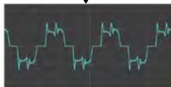
VP3000 з технологією низьких гармонік THDi 35%
