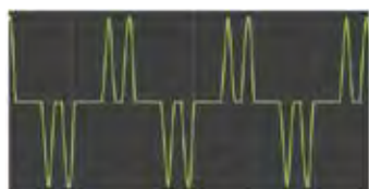
Перетворювач без DC-дроселя THDi 107%
