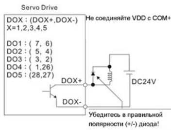
C8: Подключение выходных сигналов (DO) при использовании внешнего источника питания для индуктивной нагрузки
