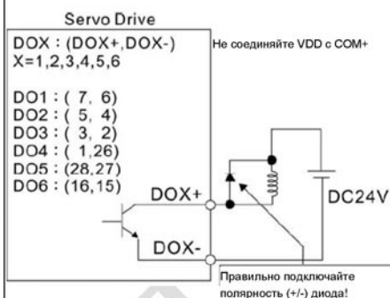
C8: Подключение выходных сигналов (DO) при использовании внешнего источника питания для индуктивной нагрузки
