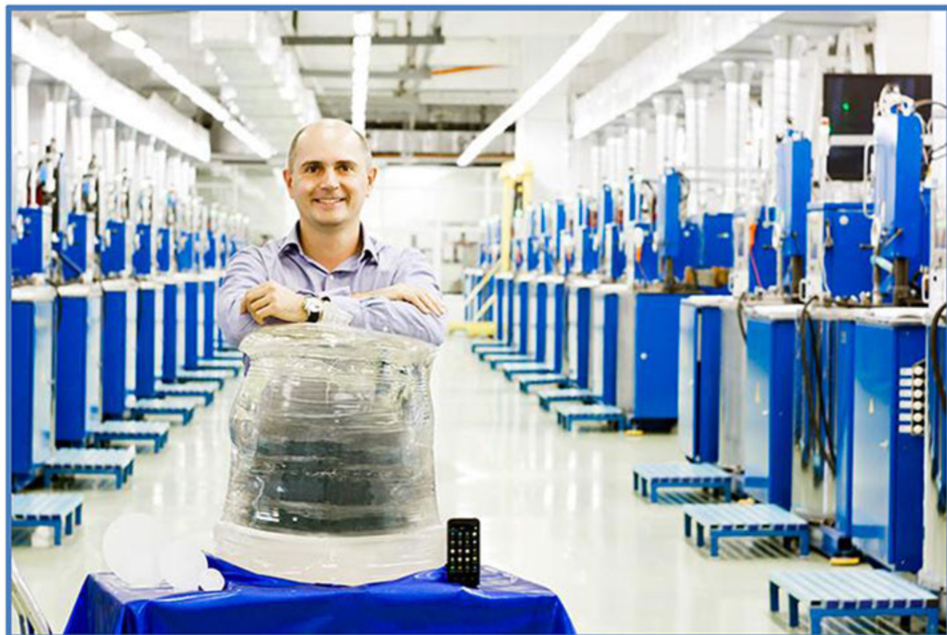
ЗАО «Монокристалл» вырастил первый в мире кристалл синтетического сапфира весом 300 кг
