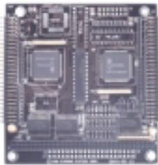
**GARNET-MM****Мощный модуль 48 каналов цифрового ввода-вывода**
