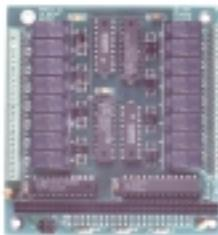
**OPAL-MM****Модуль оптически изолированного цифрового ввода и релейного вывода**
