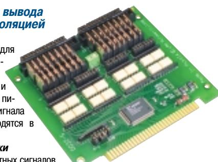
Модуль предназначен для коммутации 32 сигналов постоянного тока. Все каналы изолированы от системы и друг от друга. После подачи питания или аппаратного сигнала RESET все выходы переводятся в выключенное состояние.
