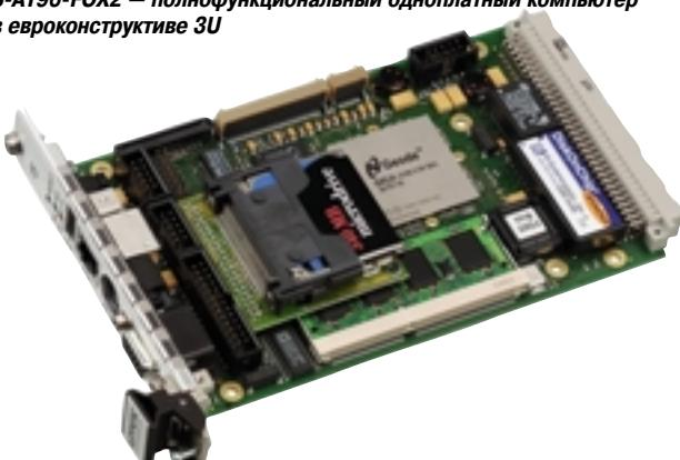
Предназначен для использования как ядро встраиваемых и промышленных компьютеров, контроллеров, серверов и терминалов; тонких клиентов, автомобильных компьютеров, медицинского оборудования, игровых и торговых автоматов.
