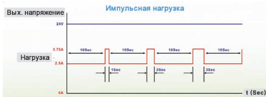
Рис. 2. Источники Delta Electronics выдерживают перегрузку 150% в течение 3 сек
