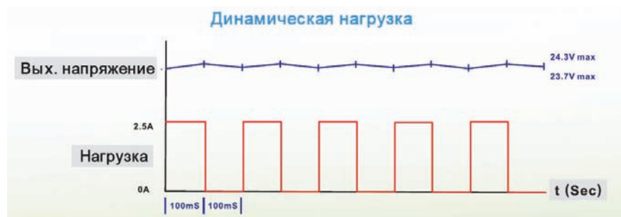
Рис. 1. Источники Delta Electronics превосходно справляются с динамической нагрузкой (здесь и далее абсолютные значения приведены для источника 60 Вт, 24В)
